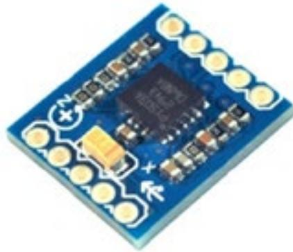
Figura 1. 2 Giroscopio. (<http://5hertz.com/tutoriales/?p=431>,2015)
