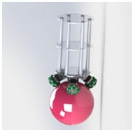
Con el diseño de la estructura se tendrá que calcular cual será el mejor punto donde poner nuestro sensor el cual será el que nos dará los grados de inclinación del robot. El punto más conveniente para ponerlo es en el centro de gravedad
